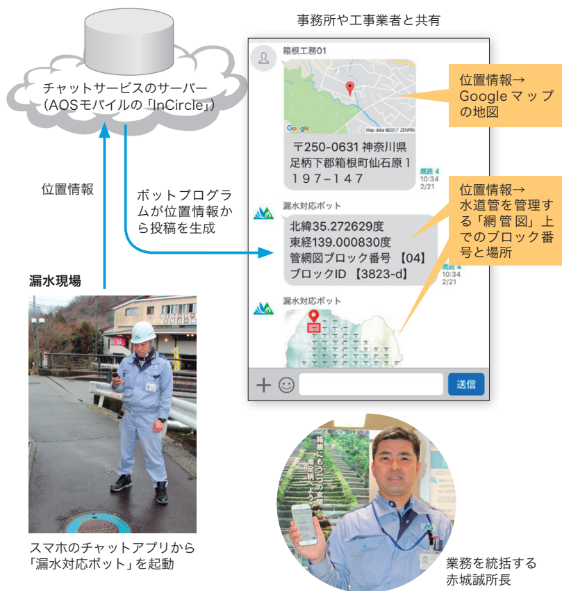
図5 神奈川県箱根町ではチャットボットで漏水現場をいち早く共有 業務を受託している箱根水道パートナーズでの活用例。現場に駆けつけた職員が「漏水対応ボット」を起動すると、位置情報を基に現場周辺地図や図面情報を関係者が共有できる。
